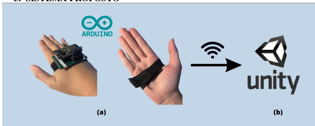
Figura 1. Diagrama funcionamento plataforma. (a) sensor para detecção de movimento. (b) decodificação do movimento pelo Unity através da comunicação Wi-Fi. (Autoria Própria)
