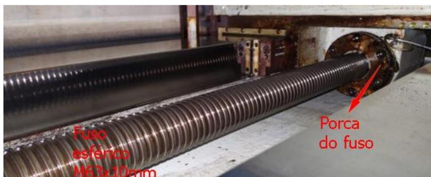
**Figura 4.** Fuso esférico recirculante de uma mandrilhadora. (Do Autor)
