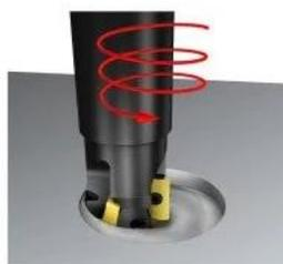
**Figura 9.** Interpolação Helicoidal. (Sandvik Coromant, 2000)
